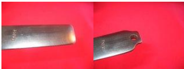
Frézované dno zásobníku nalevo z M48.
