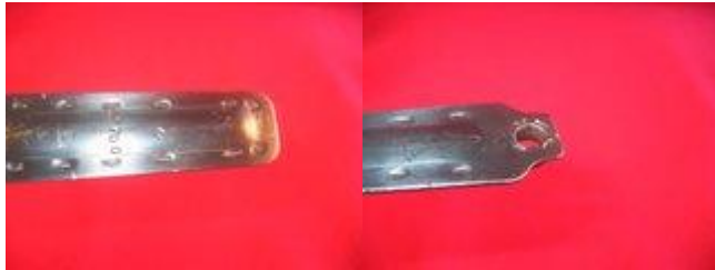
Lisované dno zásobníku napravo z M48BO.
